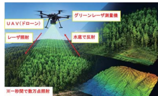
図-3 水面・水底を計測可能な UAV グリーンレーザ測量
