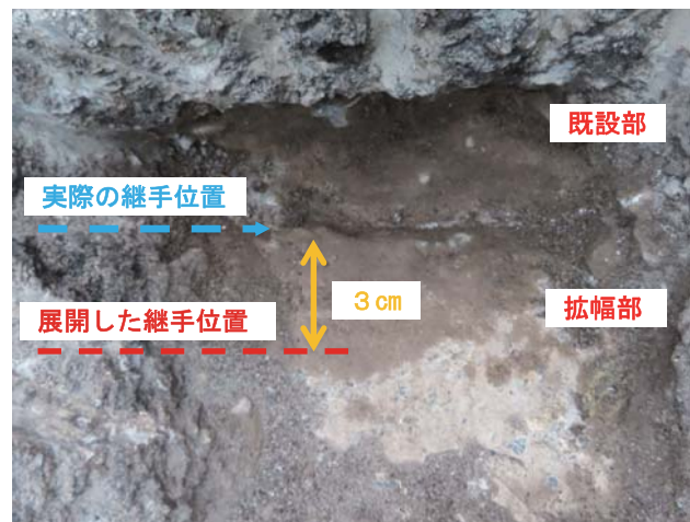
写真-12 舗装厚調査結果の状況（写真-11拡大図）
