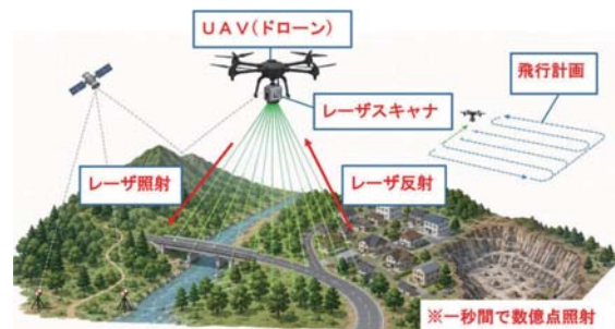
図-4 草木の下を計測可能な UAV レーザ測量
