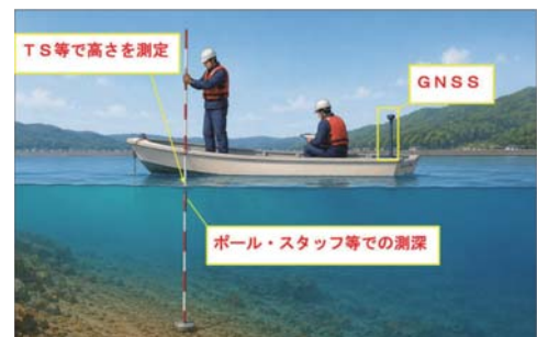
図-5 ロッド測深による深淺測量(従来手法)
