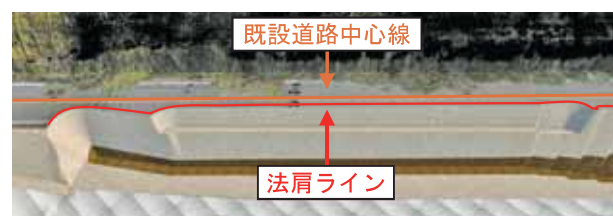
図-6 掘削法肩ラインの確認
