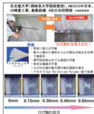
図-5 KKクラックセンサの概要
