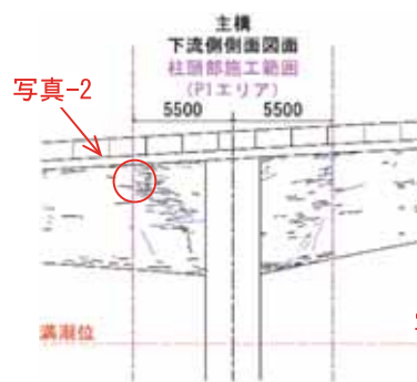
図-1 P1エリア主構の損傷図（抜粋）
