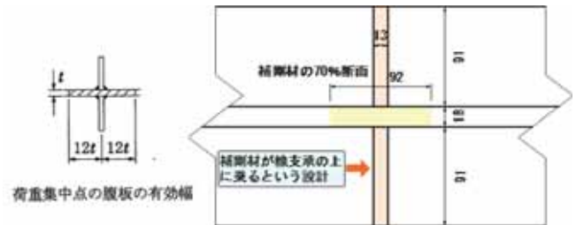
図-5 腹板と補剛材断面図 2)
