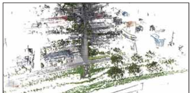
図-4 LidarSLAMによる観測点群
