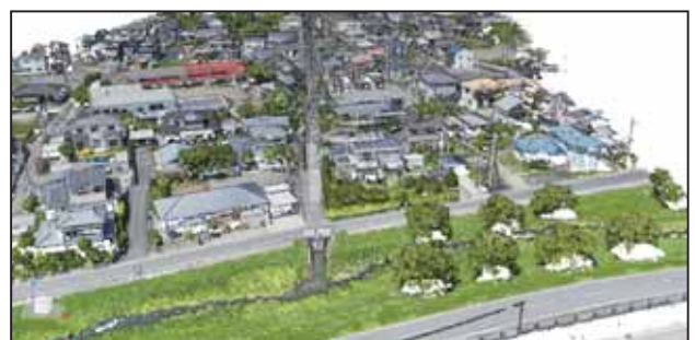
図-5 LidarSLAM+UAVによる観測点群
