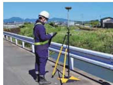
写真-4 ネットワーク型RTK
