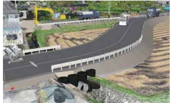
写真-9 点群データと3Dモデル（道路）
