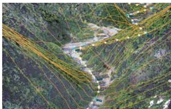
写真-5 UAVレーザで取得した点群データ (グラウンドデータ)
