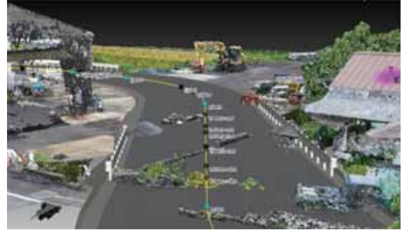
写真-8 点群データと3Dモデル（道路）
